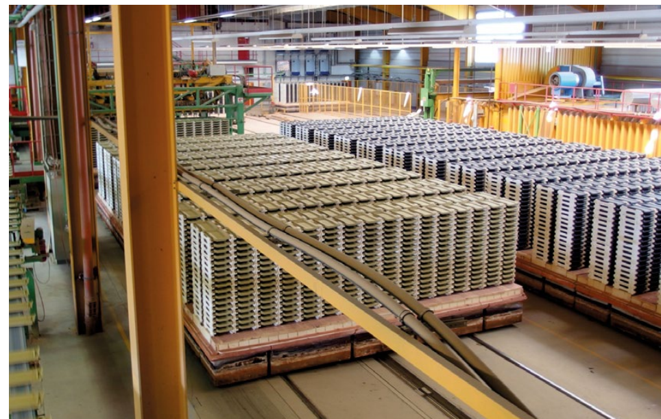
Technologia wypalania na płasko w pojedynczych „H-KASETACH”
